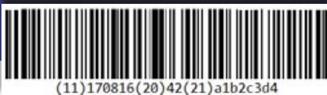
Příklad zakódování tří položek do jednoho GS1-128 kódu.
